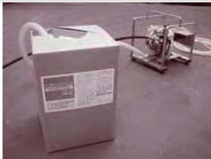
本剤は、オーステナイト系ステンレス鋼の酸洗清浄用として開発されたスプレー用粘着酸で、酸洗用吹き付けスプレー機で使用すると効率よく酸洗処理が行え、十分な酸洗効果が得られます。
