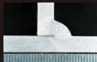
水平すみ肉溶接断面マクロ (6mmt、亜鉛目付量>450g/m 2 )
