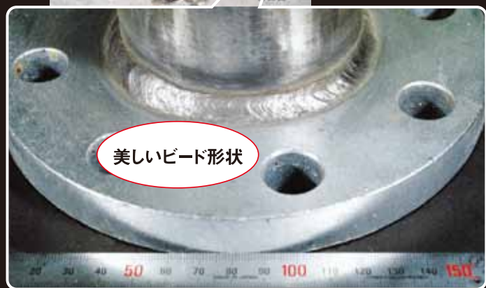
▲白ガス管80Aとフランジの接合
